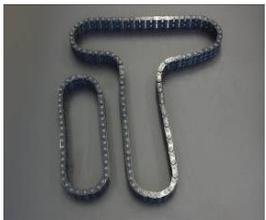
この強化チェーンは金属表面に5~10μmの比較的薄いリン酸マンガン系の不溶性皮膜を生成させ、素材表面に均一にムラなく浸透させたものです。これにより、4倍の耐摩耗性を実現！長期間に渡りチェーンの伸びによるバルブタイミングの遅れを抑えられベストコンディションを維持します。また、チェーン摺動部によく発生する焼きやカジリにも強く、しなやかな動きをキープできフリクションロスの軽減にも役立ちます。
