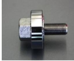
高回転時に発生するクランクシャフトのネジレ振動や曲がり振動は、プーリーボルトに大きな負荷を与えるためにボルト緩みに至ることがあります。それにより、クランク先端のカジリやプーリートラブル、オイル漏れ等に被害が及ぶ恐れがあり大変危険です。強化プーリーボルトはロングボルトと強化ワッシャーによってボルトの緩みを防止しエンジンをトラブルから守ります。
